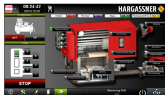
Test delovanja relejev, tipal in motornih pogonov
