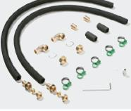
Priključni set za montažo sončnih kolektorjev FKC-2 z integriranjem v ostrešje <sup>(1)</sup> poševne strehe, uporablja se v vsaki vrsti kolektorjev. Sestavljen iz: posebne gumijaste pletene cevi (dolžine 1 meter), hitrih kotnik spojk in priključnih elementov z dvojnim konusom Ø ¾" × 18 mm.     | 7735600336         | na zahtevo               |
