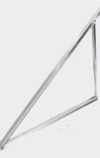
Dodatna konstrukcija z naklonom za ojačitev vertikalnih kolektorjev na ravno streho, za zgradbe višine od 20 m do 100 m ali ob snežni obremenitvi od 2,0 do 3,8 kN/m <sup>2</sup> . V primeru uporabe seta za dodatno ojačitev FKF7-2 se dodatna konstrukcija namesti blizu četrtega, sedmega in desetega kolektorja. Sestava: aluminijasti podstavek z izbiro naklona od 30° do 60° in pribor za pritrditev. Najpogosteje se povezuje s setom FKF4-2. | 8718531036         | 79,00                    |
