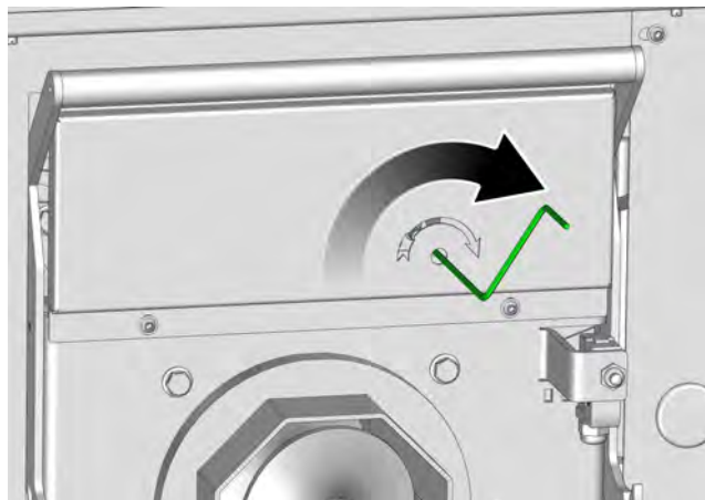
Sl. 8-9: Pravilna smer vrtenja za kotle z odvzemanjem goriva na levi strani
