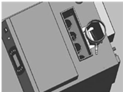
Dimovodne cevi kotla (4kom)
